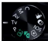
Bei der **Blendenautomatik TV** gibst du die Verschlusszeit vor, die Kamera wählt die passende Blendeneinstellung.
